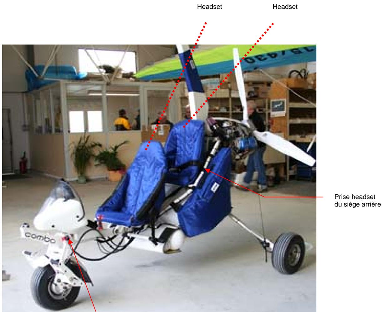
Bouton PTT à positionner sur la barre de contrôle de l'aile
